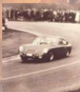
APAL GT-Horizon: 25 exemplaires construits en 1968. Construction monocoque en polyester
