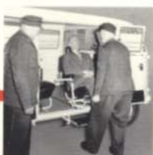
Sans que le malade doive changer de position, le fauteuil est placé sur les glissières.
