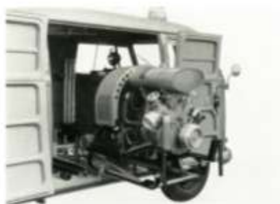
Durch die breite Zweiflügeltür ist die Tragkraftspritze TS 8/8 mit VW-Industrie-Motor leicht erreichbar und sekundenschnell einsetzbar.
