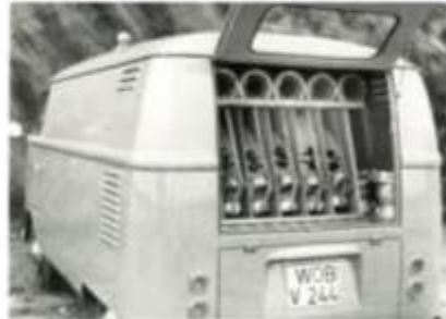
Praktisch, übersichtlich handgerecht untergebracht und damit blitzschnell greifbar: die A- und B-Schläuche hinter der Hecktür.
