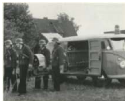
Durch die breite Zweiflügeltür ist die Tragkraftspritze TS 8/8 mit VW-Industrie-Motor leicht erreichbar und sekundenschnell einsetzbar.
